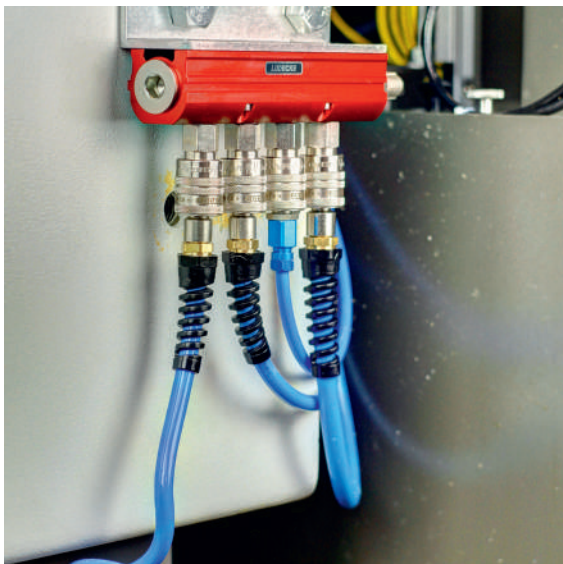
Einhandbedienung: Die Verbindung erfolgt durch einfaches Eindrücken des Stecknippels in die Kupplung.
