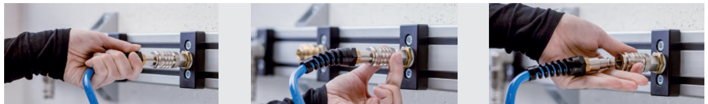
Einhandbedienung: Die Verbindung erfolgt durch einfaches Eindringen des Stecknippels in die Kupplung, Sicherung der Entriegelungshülse durch Gegenschrauben der Kontermutter
