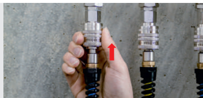
Entkuppeln - Stufe 1: Automatisches Entlüften
